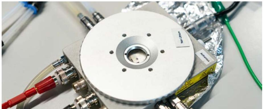
Die *Green Energy Tech-Revolution* vorantreiben: Das Ziel hat Prof. Jennifer Rupp (links) stets vor Augen. Sie forscht an Festkörpermaterien und wie sich diese als funktionale Bauteile für Energiekonversions- und Speicherkonzepte nutzen lassen. Eine Dünnschichtprobe (rechts) wird auf einem beheizbaren Messaufbau unter atmosphärischen Bedingungen getestet. So analysieren die Forschenden, wie sich die Eigenschaften bei Temperatur- und Umweltveränderungen verhalten.
