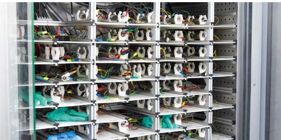
Batterien im Test: Im Klimaschrank (links) testet das Forschungsteam um Prof. Hubert Gasteiger (rechts) bis zu 100 Batteriezellen gleichzeitig. Unter kontrollierten Temperaturbedingungen durchlaufen sie Lade- und Entladezyklen, um ihr Verhalten und ihre Lebensdauer zu untersuchen. Getestet werden dabei unterschiedlichste Zelltypen – von kleinen Laborzellen bis hin zu Formaten, die kommerziellen Batterien bereits sehr nahekommen.
