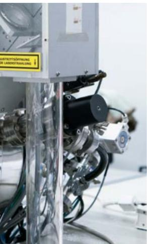
Mit dem Pulsed-Laser-Deposition-System (rechts) lassen sich ultradünne Materialschichten sehr präzise herstellen. Damit kann das Forschungsteam um Prof. Jennifer Rupp die Zusammensetzung, Dicke und Kristallinität im Nanometerbereich kontrollieren. Mit verschiedenen Schablonen (links) steuern die Forschenden aus Rupp's Team gezielt, wo sie Metalle auf eine Probe aufbringen und untersuchen die elektrochemischen Transporteigenschaften etwa auf Dünnschichten oder Keramiken.
